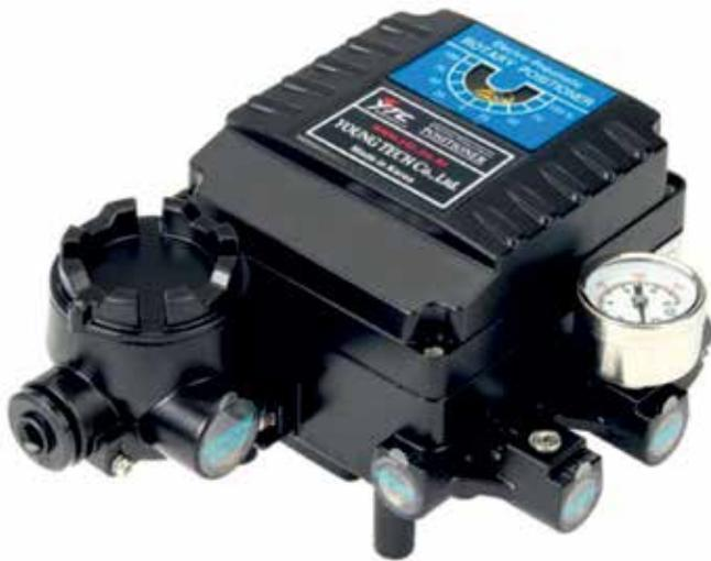
El posicionador electroneumático YT1000R se usa para el funcionamiento de actuadores de válvula rotativa neumática, por medio de un controlador eléctrico o sistema de control con una señal de salida analógica de DC4 a 20 mA o rangos divididos.
